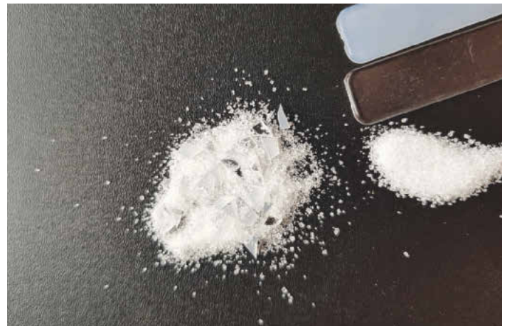
Echtfarbenbild von mit Kunststoffsplintern verunreinigtem Zucker (links vermischt, rechts separat)
