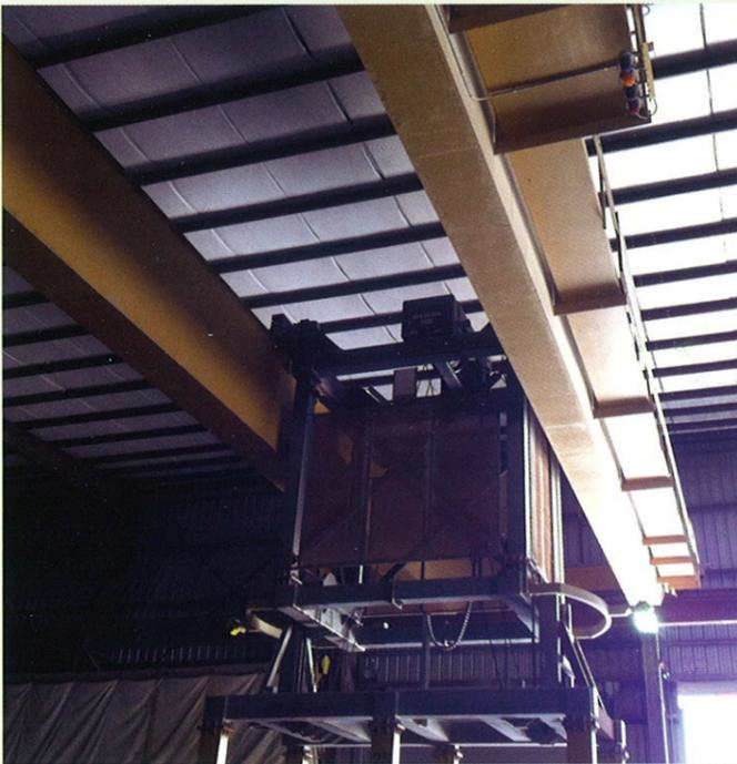
BILD 1: Brückenkran nach der Modernisierung
