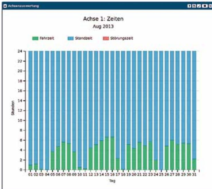
In einem Balkendiagramm kann die Auslastung der Maschine dargestellt werden.
