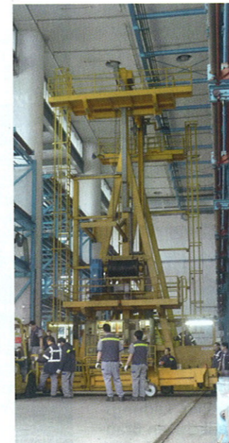
Das modernisierte ETV für die bis zu 13,6 t schweren Luftfrachtcontainer
