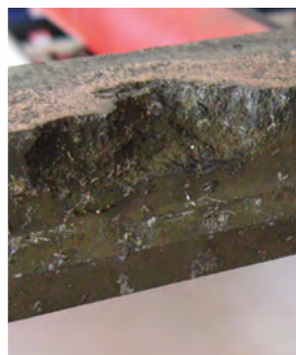
Schleifleiste mit herausgebrochenem Fragment
